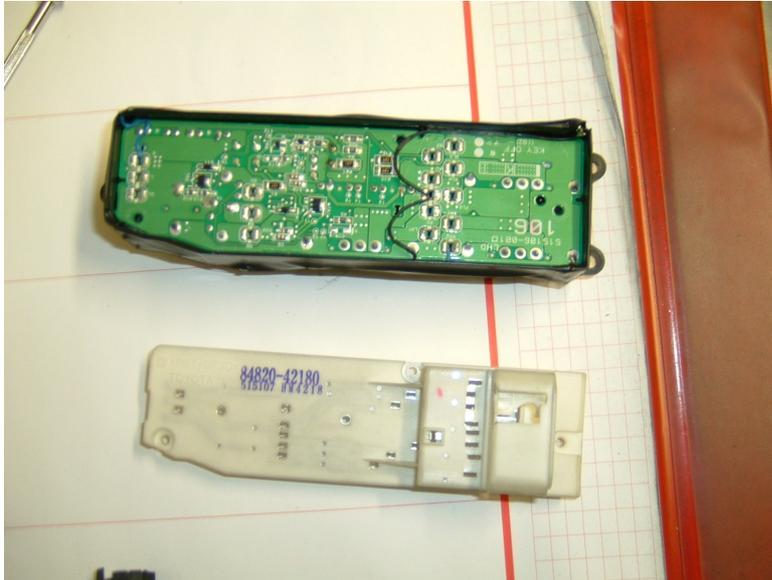
bis man 6 LED in Reihe gelötet hat. Natürlich passen die Anschlußdrähte der LED nicht immer. Sollten sie zu lang sein, dann schneidet man sie auf Länge, sollten sie zu kurz sein, dann wird mit Hilfe der Litze eine Brücke gelegt.
