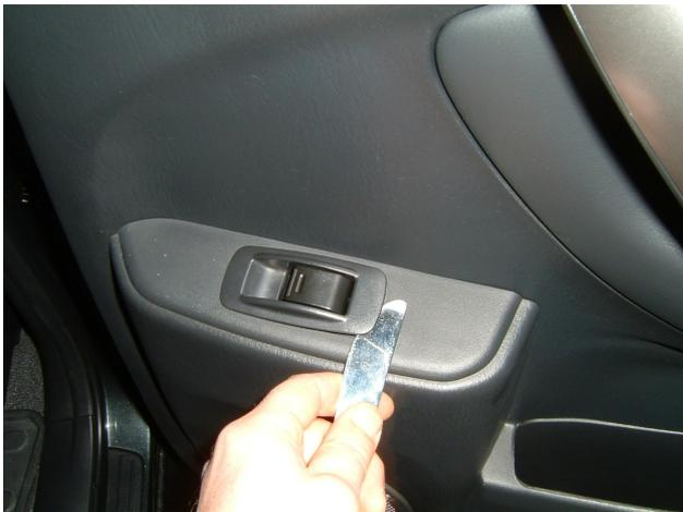
Entferne den Schalter mit dem Messer aus der Halterung. Dazu das Messer „hinten“ am Schalter ansetzen und den Schalter „heraushebeln“. Am Schalter den Stecker der elektr. Zuleitung entfernen, indem man den Kunststoffclips eindrückt.
