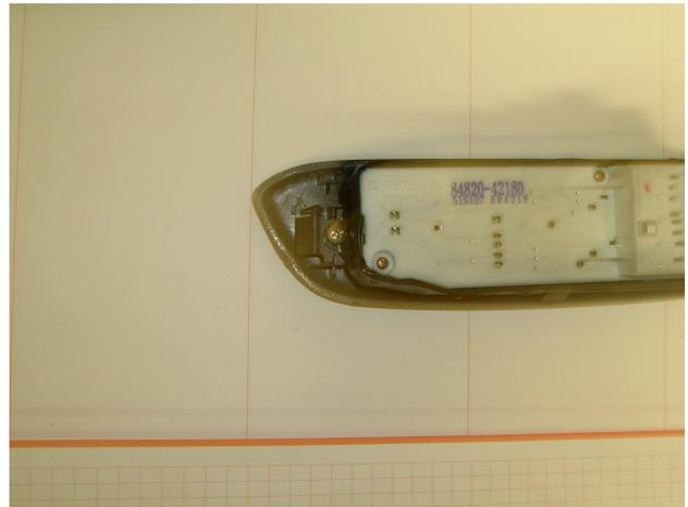
Die drei großen Kreuzschrauben und die Metallklammer entfernen. Anschließend die Blende abnehmen - fällt nach dem Entfernen der Schrauben meist von alleine ab.
