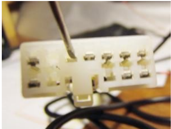
Abbildung 3: Entfernen einer Metallhülse mit Schraubendreher
