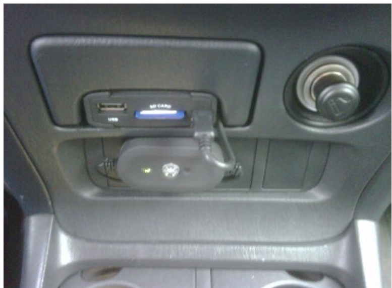
Abbildung 5: Fertiger Einbau. links USB, mitte SD(HC), rechts das Kabel zum Bluetooth-Modul. Unten: Bluetooth-Modul
